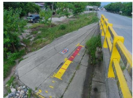
para medir la precipitación acumulada usando pluviómetros simples y escalas de nivel de río.
